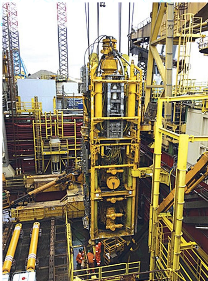
Figura 3. LMRP/SSBOP. Fuente: Oilgear; Fluid Power Journal (2020).
