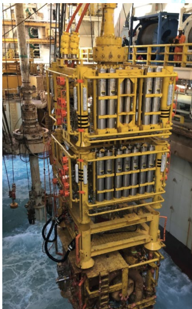
Figura 2. Sistema de Riser de Intervención (IRS) de Expro durante una operación de P&A en África. En la parte superior la junta de seguridad conectada al conjunto EDP/LRP, cada uno con su conjunto de acumuladores. De igual forma se observa la terminación de las líneas de control en el EDP. Fuente: Expro.
